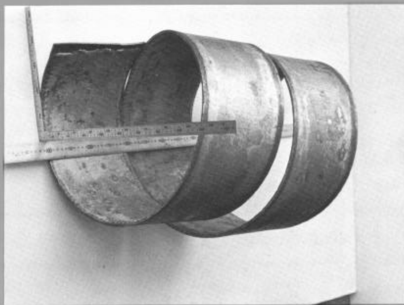
【200mm幅のING-PLATE “FLEXY-SA”を螺旋状に曲げ加工】
